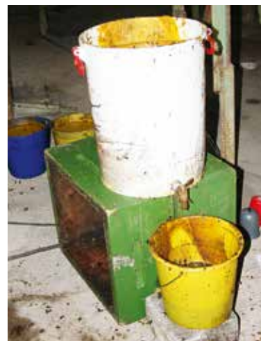
Hobbock mit Auslauf, zum leichten, unkomplizierten Trennen von Wasser und Wachs nach dem Pressen bzw. Sieben.
