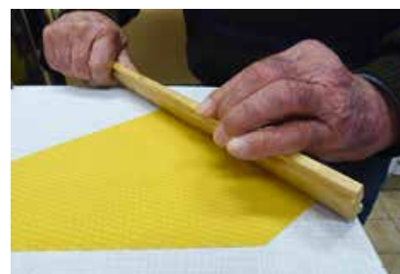
Abb.4 a bis f: Die Mittelwand wird in die Nut des Profilholzes gesteckt. Das Profilholz um 180° drehen, so entsteht eine U-förmige Biegung. Dorthinein wird der Docht gelegt. Die Kerze nun um den Docht drehen. Die hier gezeigte Kerze entspricht der roten Linie im Schnittmuster Abbildung 1.
