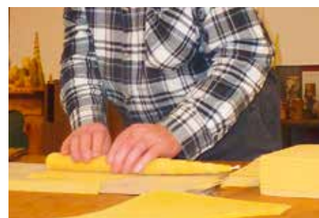
Abb.4 a bis f: Die Mittelwand wird in die Nut des Profilholzes gesteckt. Das Profilholz um 180° drehen, so entsteht eine U-förmige Biegung. Dorthinein wird der Docht gelegt. Die Kerze nun um den Docht drehen. Die hier gezeigte Kerze entspricht der roten Linie im Schnittmuster Abbildung 1.
