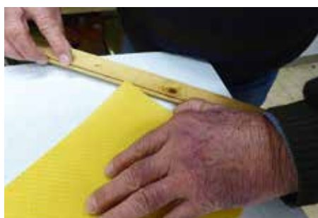
Abb.4 a bis f: Die Mittelwand wird in die Nut des Profilholzes gesteckt. Das Profilholz um 180° drehen, so entsteht eine U-förmige Biegung. Dorthinein wird der Docht gelegt. Die Kerze nun um den Docht drehen. Die hier gezeigte Kerze entspricht der roten Linie im Schnittmuster Abbildung 1.
