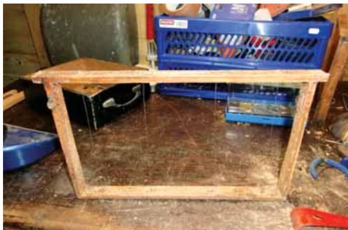
Erst reinigen, dann neu bedrahten und die Mittelwand einlöten.
