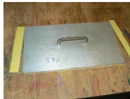
Bild 15: Mittelwand wird mit einer Schablone auf Maß geschnitten.
