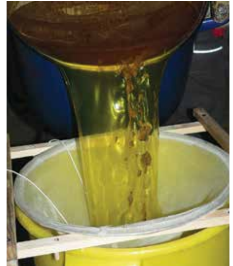
Bild 9: Abseihen des Wasser/Wachsgemisches.
