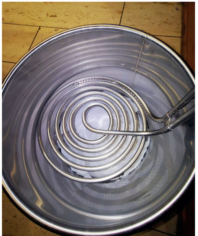
Melitherm Heizspirale auf Sehtuch im Aufsatz.
