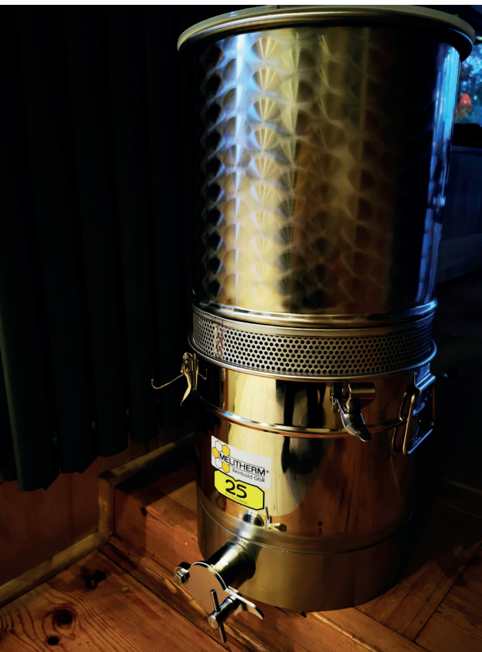
Melitherm Gesamtansicht mit Lochblechring zwischen Aufsatz und Abfüller – dieser unterstützt das Abführen von Feuchtigkeit.
