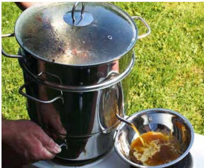
Abb.5: Einschmelz-Alternative für Kleinstimker: ab 30,- Euro kostet ein Edelstahl-Dampfensafter. Zur Freude der Küchenchefin kann er vom Imker bienendicht und damit geschützt vor Räuberei auch auf einer Kochplatte im Garten betrieben werden. Ohne Einsatz zusätzlicher Siebe wird damit aus wenigen schmutzigen Wachsstücken schnell goldener Saft. Andere günstige Schmelzervarianten kosten mindestens 120,- Euro. Für diesen Betrag kann der Dampfensafter nach Abzug der Anschaffungskosten etwa 510-mal betrieben werden.
