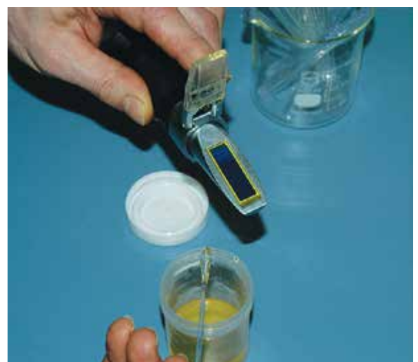
Zum Wassergehalt messen muss der Honig noch klarflüssig sein. Das Refraktometer ist ein empfindliches Gerät.
