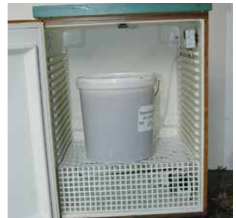
Abb.2: Wiederverflüssigen in selbstgebauten Wärmeschrank: sicher u. schnell.
