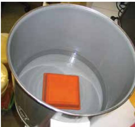
Abb.1: Wiederverflüssigen im Wasserbad: Einstellen des Vorratsbehälters ins Wasserbad auf eine Unterlage, Deckel muss dicht sein, nicht über 40° C erwärmen.
