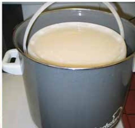
Abb.1: Wiederverflüssigen im Wasserbad: Einstellen des Vorratsbehälters ins Wasserbad auf eine Unterlage, Deckel muss dicht sein, nicht über 40° C erwärmen.
