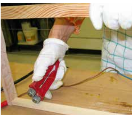
Abb.3: Der Wabendrahtspanner legt Drähte in Zickzack. Schon wenige bearbeitete Zentimeter machen Drähte ausreichend stramm.
