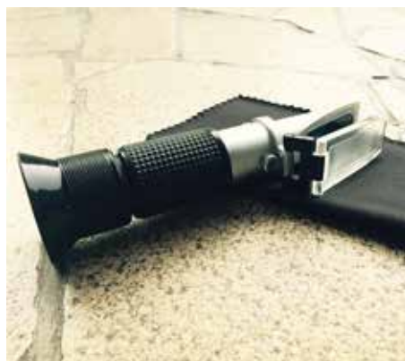
Refraktometer. Es nutzt dafür das Verhalten von Licht am Übergang zwischen einem Prisma mit bekannten Eigenschaften und dem zu prüfenden Stoff, hier Honig.
