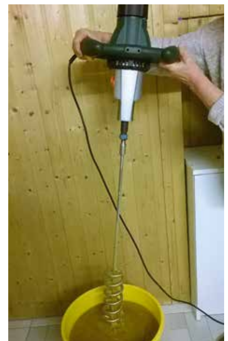
Robuster Rührer mit Getriebe und Drehzahlsteuerung.
