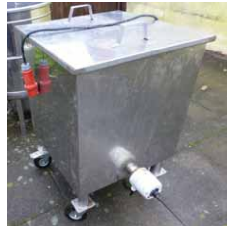
Hygienewagen für die Sanierung von Imkereien. Läuft sowohl mit Gas wie auch mit Strom.
