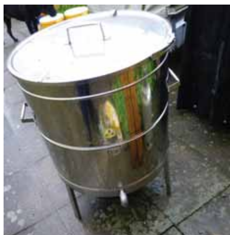
Ein größerer Dampfwachsschmelzer für ca. bis zu 50 Rähmchen geeignet. Kann ebenfalls mit Gas und Strom betrieben werden.
