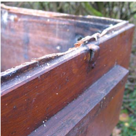
Abb.1: Der Falz – auch bei sorgsamem Gebrauch ständig ramponiert und reparaturanfällig.
